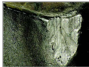
Microrrotura y desgaste por soldadura
